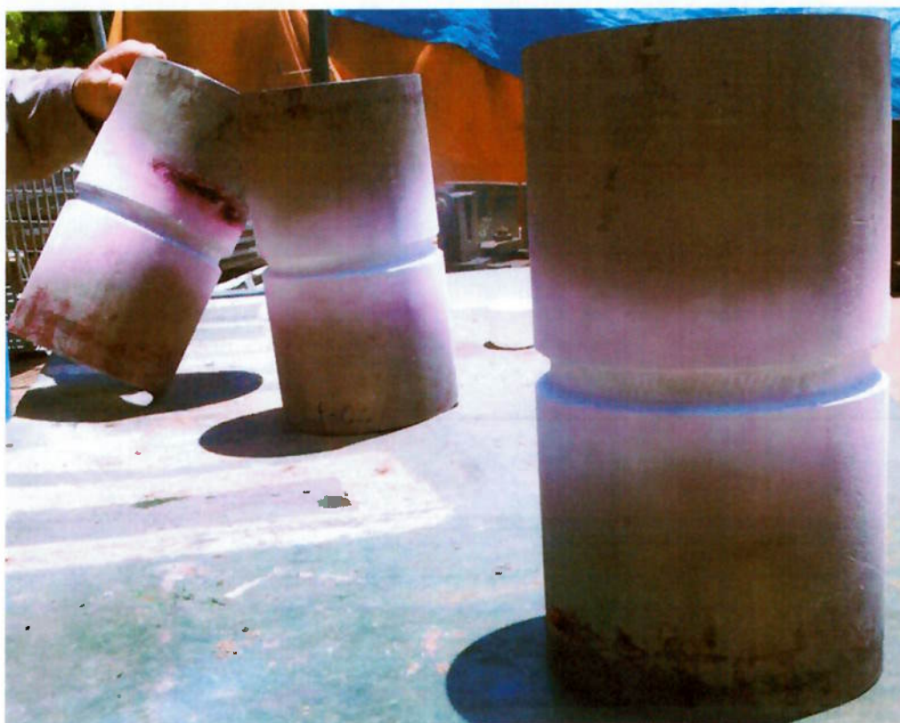
Figura 5.1 - Aplicação do Revelador Durante o Ensaio por Líquido Penetrante na Raiz dos CPs.
