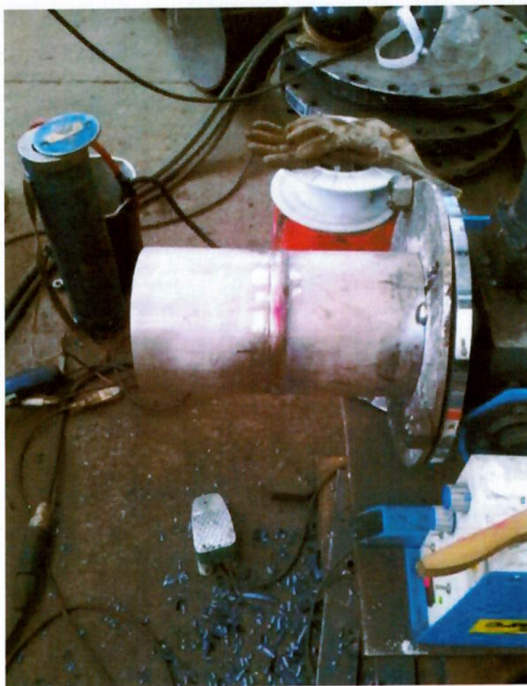
Figura 4.4 - Mesa Giratória Utilizada nos Passes de Enchimento e Acabamento.
