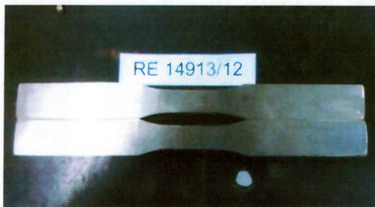
Figura 4.10 - Preparação das Amostras para o Ensaio de Tração.
