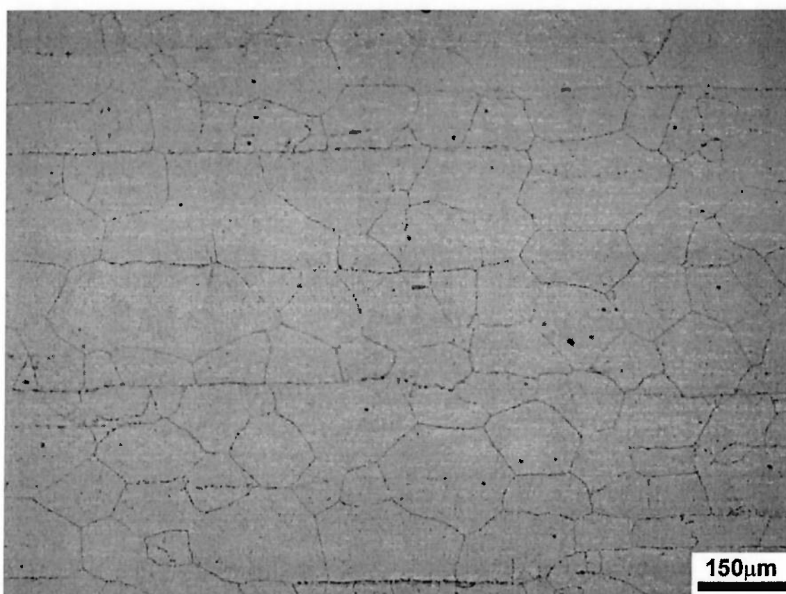
Figura 5.4 - Imagem do Metal de Base do CP 120HTT com Aumento de 100X.
