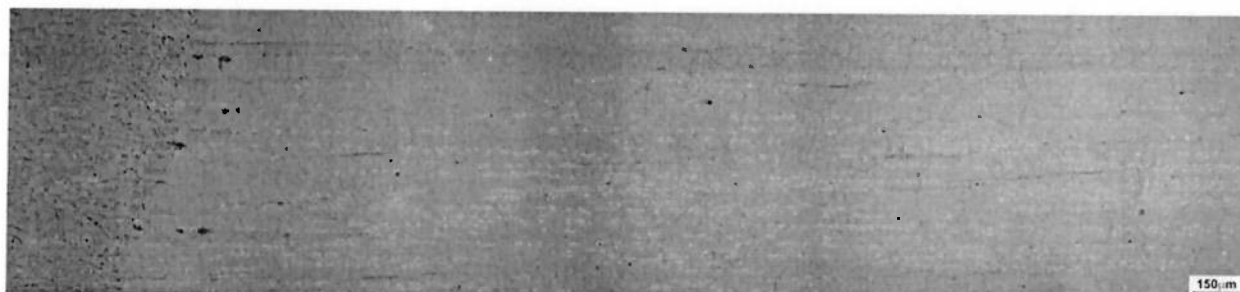
Figura 5.29 - Faixa Inferior do CP 1HTT com Aumento de 100X.
