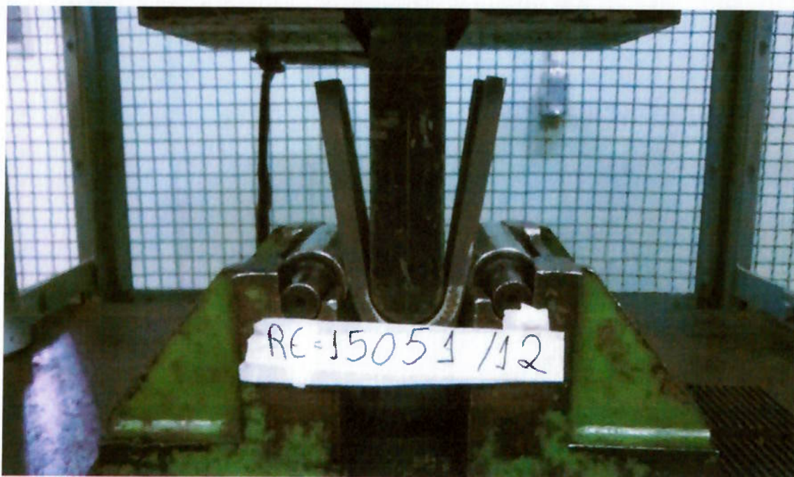
Figura 4.9 - Realização do Ensaio de Dobramento.
