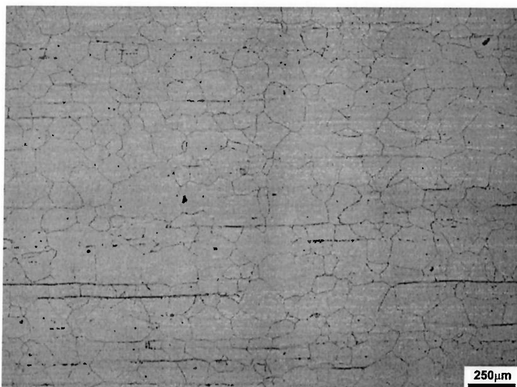
Figura 5.23 - Metal de Base do CP SemTT com Aumento de 50X.
