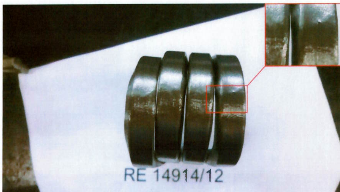
Figura 5.2 - Descontinuidade em Amostra de Dobramento do 1HTT.
